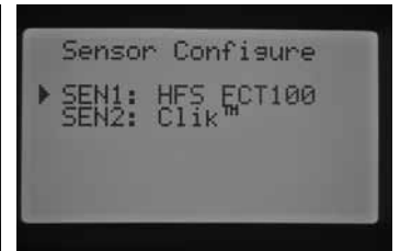
SEN1 - átfolyás érzékelő (HFS FCT100) SEN2 - mikrokapcsolós érzékelő
