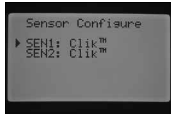
SEN1 és SEN2 - alapállapotban zárt mikrokapcsolós érzékelő
